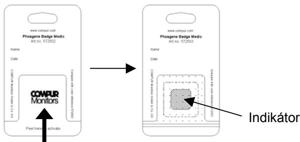
Štítek umístěte do blízkosti dýchacích cest. Dávejte pozor, aby nedošlo k zakrytí místa pro vstup plynu do indikátoru. Připevněte štítek přímo na oblečení nebo použijte sponu. Nepoužívejte štítek déle než 5 dní. Znečištěný nebo poškozený štítek okamžitě vyměňte, abyste předešli zobrazení nesprávných hodnot.
