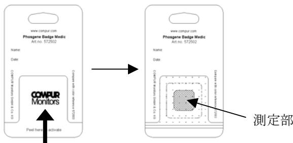
バッジは呼吸ゾーンの近くに身に着けてください。測定部にあるガス検知部を覆ってしまわないように気をつけてください。バッジは衣服にボタンで直接取り付けるか、クリップを使用してください。バッジを5日以上使用しないでください。誤測定を避けるため、バッジが汚染されている、または損傷がある場合は、直ちに交換してください。
