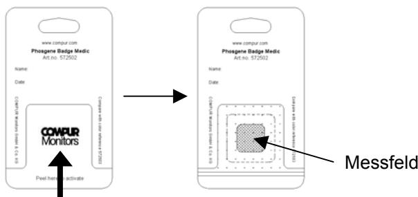
Die Plakette soll möglichst in Gesichtsnähe getragen werden. Sie kann direkt an einem Knopf oder mit Hilfe eines Clips befestigt werden. Tragen Sie die Plakette immer mit der bedruckten Seite nach vorne!
