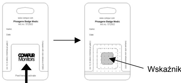
Sensor należy umieścić blisko strefy oddychania. Dostęp gazu do wskaźnika nie może być zablokowany. Sensor należy zamocować bezpośrednio na ubraniu lub przy użyciu klipsa. Nie używać sensora dłużej niż 5 dni. W celu uniknięcia nieprawidłowych odczytów należy niezwłocznie wymienić zanieczyszczone lub uszkodzone sensory.
