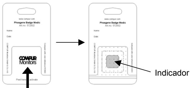
Llevar la placa indicadora cerca de la zona de su respiración. Tenga cuidado de no tapar el acceso del gas a la placa indicadora. Fijar la placa directamente a su ropa mediante botón o clip. No usar la placa indicadora para un tiempo superior a 5 días. Sustituir placas contaminadas o dañadas inmediatamente, para evitar lecturas erróneas.
