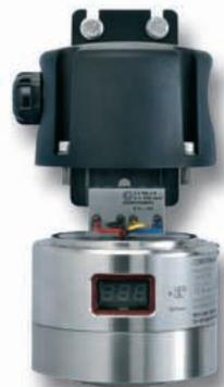
Un faisceau de référence avec une longueur d'onde différente permet de compenser la déviation qui serait causée en présence de poussière, d'humidité ou en cas de variation de l'intensité lumineuse de la source.
