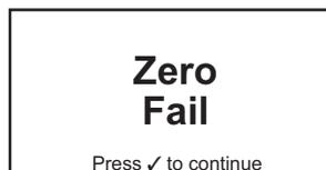
Si el ajuste a cero no se ha realizado correctamente, repita el proceso asegurándose de que el instrumento se encuentra en un entorno de aire fresco. Si se produce un nuevo error, deberá sustituir el cartucho. Una vez completado correctamente el ajuste a cero, hay que llevar a cabo una calibración span.
