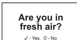
Si pulsa el botón ✓, el instrumento ajustará los sensores a cero automáticamente e indicará si el proceso ha concluido satisfactoriamente. La lectura de oxígeno quedará ajustada a 20,9% v/v y las lecturas del resto de sensores se ajustarán debidamente a 0 ppm y 0% LEL. En cambio, si pulsa el botón ⊖, el instrumento utilizará los valores cero que contenga y pasará a la pantalla de supervisión.
