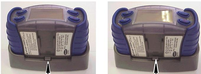
(Desacoplado) Cierre de seguridad trasero (Acoplado)
