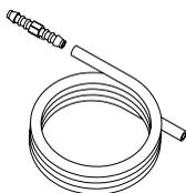
Aumenta el alcance del instrumento y puede utilizarse con un aspirador manual o un adaptador de bomba. Se suministra con un acoplador y puede ampliarse a más de 10 m adquiriendo juegos adicionales de tubos. La longitud máxima recomendada es de 20 m, en cuyo caso habría que ajustar convenientemente la duración del muestreo.
