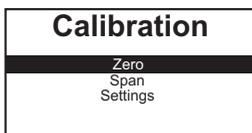
El procedimiento de calibración precisa una puesta a cero seguida de un span. El span requiere una concentración específica de gas de calibración que se ajuste a la indicada en las configuraciones. Seleccione la opción correspondiente.
