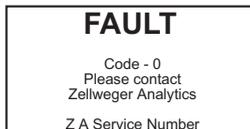
Si detecta una condición de fallo durante la puesta en marcha, o posteriormente, el instrumento muestra un mensaje de advertencia al usuario y le facilita un número de contacto. El mensaje permanecerá en pantalla hasta que se apague el instrumento pulsando el botón ① como mínimo durante 3 segundos.
