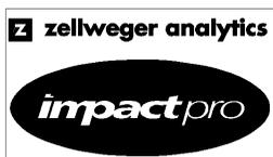
Esta primera pantalla identifica el modelo. Mientras se muestra esta información, las alarmas están siendo probadas. Si el modelo incorpora una alarma vibratoria, también se activa. Si pulsa el botón **ⓘ** mientras aparece esta pantalla, el instrumento identificará la versión del software instalado y su número de serie.
