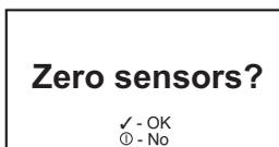
Al activar esta opción, el instrumento le solicitará si desea ajustar a cero los sensores en aire fresco para compensar cualquier cambio natural que pueda haberse producido. Si pulsa el botón ✓, el instrumento le pedirá que se cerciore de que el ajuste a cero se está realizando en un entorno de aire fresco no contaminado.
