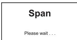
Appuyer sur le bouton ✓, l'instrument affiche alors le message suivant pendant le réglage du point de consigne dynamique du capteur.
