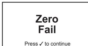
Si la mise à zéro a échoué, renouveler l'opération en veillant à placer l'instrument à l'air frais. En cas de nouvel échec,
