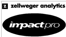
Le premier affichage identifie le modèle. Les alarmes sont testées pendant l'affichage de cet écran. L'instrument vibre également s'il est muni d'un vibreur. Si l'on appuie sur la touche ① pendant l'affichage de cet écran, l'instrument identifie la version du logiciel installé ainsi que son numéro de série.
