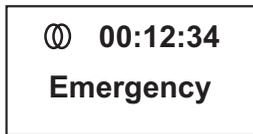
L'écran d'état indique la durée de fonctionnement du mode Safelink et l'état de la connexion : normal, urgence ou interconnexion défectueuse.
