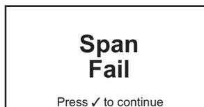
Si le réglage du point de consigne dynamique a échoué, renouveler l'opération en s'assurant que la concentration du gaz d'étalonnage est correcte, qu'il y a suffisamment de gaz dans la bouteille et que le débit est adéquat.
