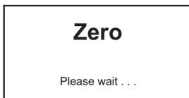
Une fois la mise à zéro terminée, l'instrument confirme la réussite ou l'échec de l'opération.
