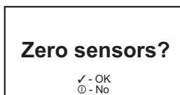
Si cette option est activée, l'instrument invite l'opérateur à mettre à zéro les capteurs à l'air frais afin de compenser toute dérive ayant pu se produire naturellement. Si l'on appuie sur le bouton ✓, l'instrument invite à confirmer que la mise à zéro s'effectue dans de l'air frais et non-contaminé.
