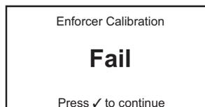
Retirer l'instrument de l'Enforcer. Si l'étalonnage avec l'Enforcer a échoué, renouveler l'opération. En cas de nouvel échec, renvoyer l'instrument pour un étalonnage en conditions contrôlées ou remplacer la cartouche.
