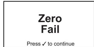
In caso di esito negativo, ripetere l'operazione di azzeramento assicurandosi che lo strumento si trovi in aria pura. In caso di un secondo esito negativo, sostituire la cartuccia. In caso di esito positivo, eseguire la taratura dell'intervallo di misura.
