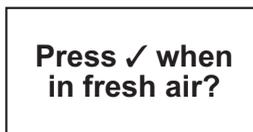
La taratura dello zero deve essere eseguita in aria pura e incontaminata. In alternativa è possibile utilizzare una riserva di aria in bombola con contenuto di ossigeno di 20,9%v/v.
