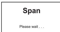
Dopo aver premuto il pulsante ✓ lo strumento visualizza questo messaggio durante la taratura dell'intervallo di misura del sensore.
