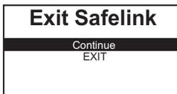
Per uscire dalla modalità Safelink, staccare il cavo che collega i due strumenti. Entrambi gli strumenti visualizzeranno un menu che consente di disattivare la modalità Safelink.
