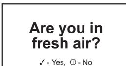
Premendo il pulsante  $\checkmark$  lo strumento azzererà automaticamente i sensori, indicando se l'operazione ha avuto esito positivo. Il valore dell'ossigeno viene regolato su 20,9%v/v, mentre le letture dell'altro sensore vengono regolate su 0 ppm e 0%lel. Premendo invece il pulsante  $\textcircled{1}$  lo strumento utilizza i valori di zero correnti e passa alla schermata di monitoraggio.
