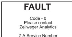
Se in fase di avviamento o successivamente viene rilevata una condizione di guasto, lo strumento visualizza un messaggio di guasto per l'utente e un numero da contattare. Tale schermata resta attiva finché lo strumento non viene spento premendo il pulsante
