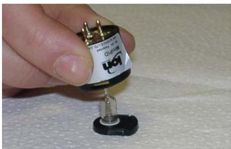
Heben Sie den Sensor vorsichtig an. Sollten Elektrodenpack und Lampe nicht von selbst herausrutschen, dann führen Sie die Kunststoffzange nochmal in die Schlitze ein und drücken Sie vorsichtig nach.
