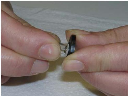
Drücken Sie die Lampe mit drehender Bewegung bis zum Anschlag in den O-Ring des Elektrodenstapels. Die Lampe muss plan auf der Elektrode aufliegen.
