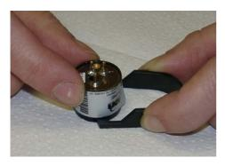
Placer le capteur sur un tissu doux et propre, les pinoches vers le haut.
