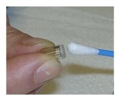
Tirer précautionneusement la lampe hors du bloc électrode. Ne jamais toucher la face polie de la lampe.
