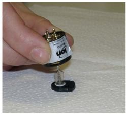
Placer le bloc électrode avec la lampe face vers le bas sur la table. Placer le capteur dessus. S'assurer que les deux parties sont bien en position.
