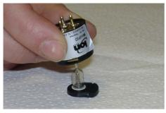
Lever précautionneusement le capteur. Si l'électrode et la lampe ne viennent pas aisément, appliquer à nouveau la pince de plastique.
